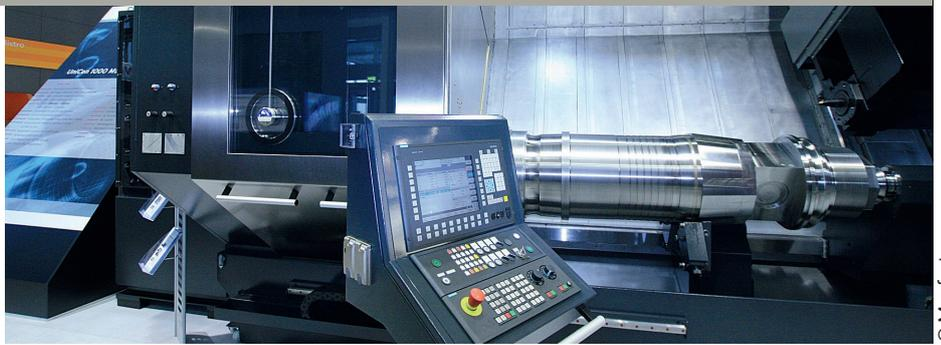
Die „Unicen 1000“ von A. Monforts Werkzeugmaschinen ist auf das Drehen, Fräsen und Bohren besonders harter Materialien spezialisiert.
