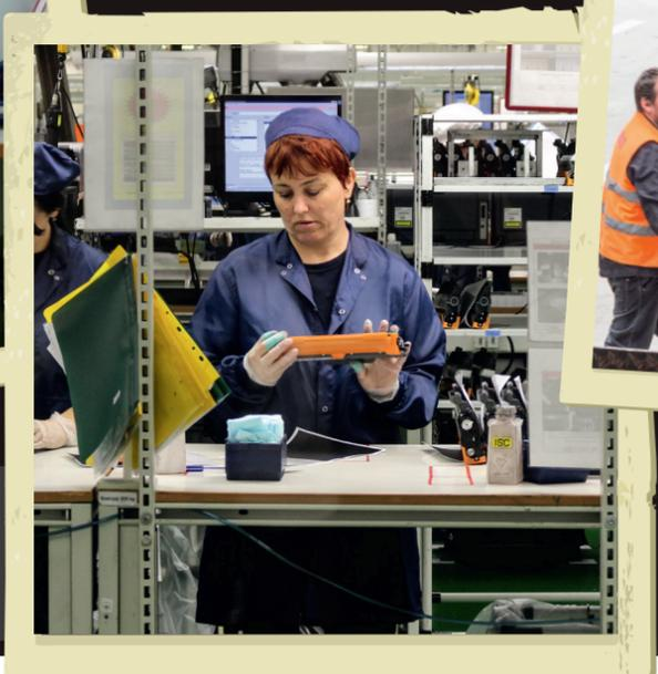
Im CleanRoom gehen die Kartuschen durch drei Stufen des Recyclingprozesses. Sie werden in ihre Komponenten zerlegt, gereinigt, wieder zusammengeschaubt und schließlich mit Tonerpulver neu befüllt.
