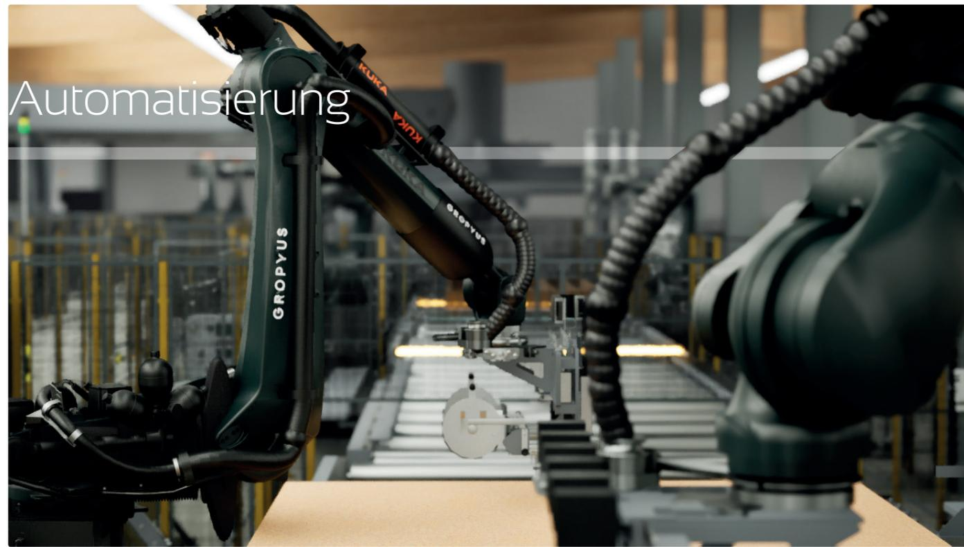
Im automatisierten Hausbau in der Fabrik ist eine Reduktion der Bauzeit um bis zu 70 Prozent möglich. Die Gesamtkosten fallen laut KUKA um ein Viertel niedriger aus im Vergleich zur herkömmlichen Bauweise. Davon können Baustellen nur träumen.
