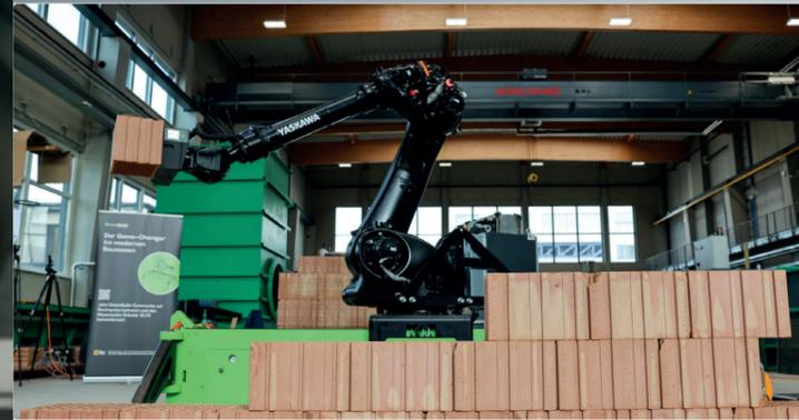
Der Roboter WLTR von Wienerberger automatisiert den Prozess des Ziegellegens.
