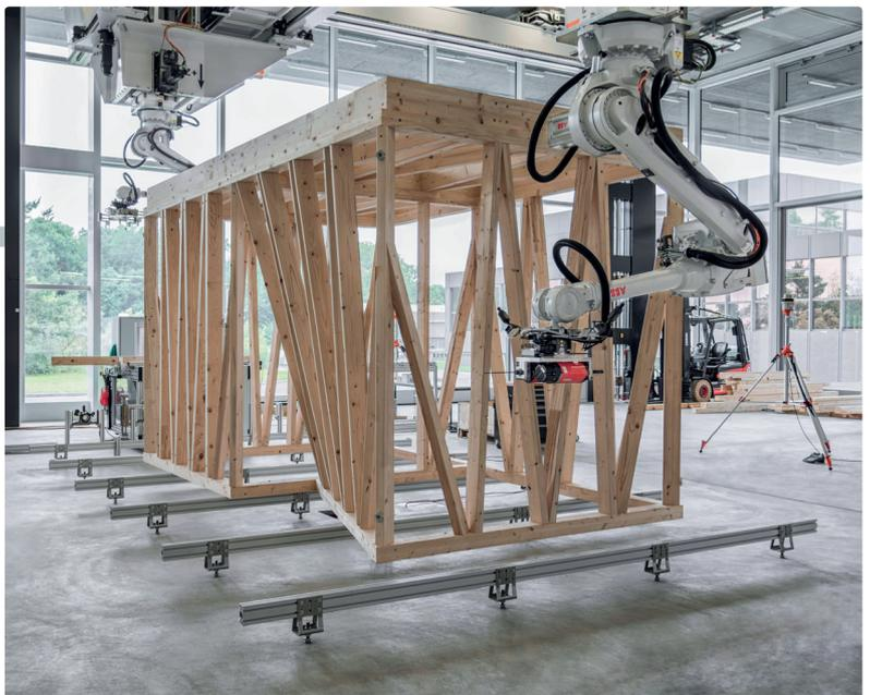
↑ ABB-Roboter setzen in der Werkhalle Betonbewehrungen und Holzkonstruktionen zusammen.
