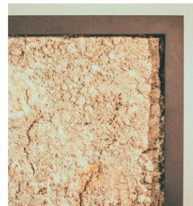
**Fortschritt Baustoff:** Aus Pilzmyzel lässt sich ein leichter und dennoch stabiler Werkstoff herstellen, der sich als Dämmstoff ebenso eignet wie für temporäre Bauelemente und tragende Strukturen.
