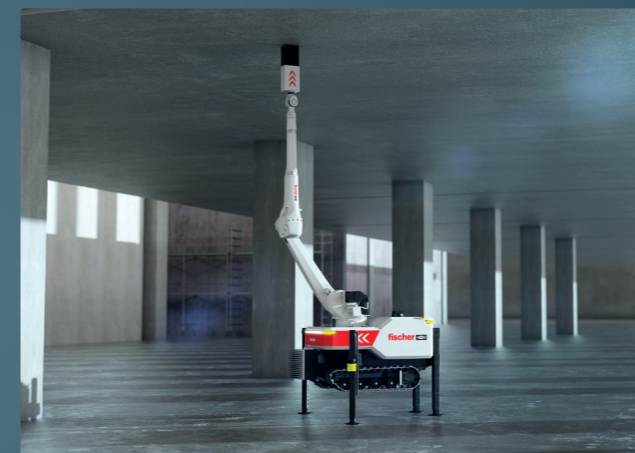
BauBot übernimmt die Bohrerherstellung präzise an im Bauplan vorgegebenen Stellen und wird in Kürze Fischer Befestigungslösungen installieren. Sind keine digitalen Daten der Baustelle vorhanden, lässt sich ein 3D-Scan durchführen.
