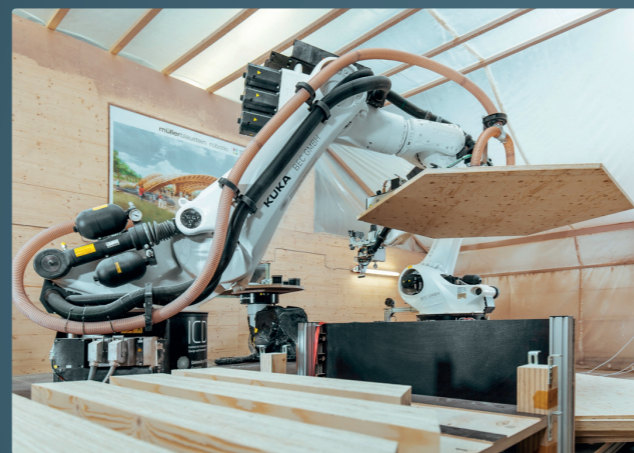
Kuka ermöglicht die robotische Fertigung in der Holzbauarchitektur. Die Verlagerung der Baustelle in die Fabrik bietet neben höherer Effektivität beispiellose Qualität, verbesserte Arbeitsbedingungen und Nachhaltigkeit am Bau.
