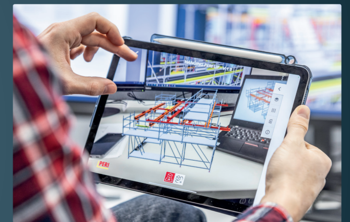
Bei Peri werden einsatzoptimierte Schalungs- und Gerüstfachmodelle mit zusätzlichen Informationen angereichert, wie z. B. Echtzeit-Sensordaten. Diese intelligente Kombination von Lösungen und Technologien verbessert Effizienz und Sicherheit auf Baustellen.
